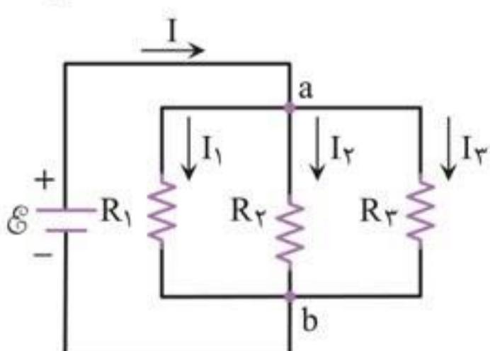
الف) مداری شامل سه مقاومت که به صورت موازی به نقطه‌های a و b بسته شده‌اند.
