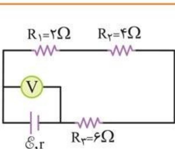
**تست:** در شکل مقابل ولتسنج  $24V$  را نشان می‌دهد. ولتاژ  $R_2$  چند ولت است؟
