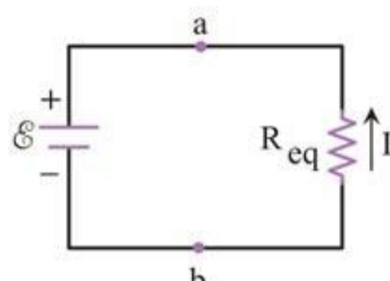
ب) مدار معادل شکل (الف) که در آن مقاومت معادل،  $R_{eq}$  جایگزین مقاومت‌های  $R_1$ ،  $R_2$ ،  $R_3$  و شده است.
