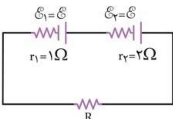
تست: در شکل مقابل مقاومت  $R$  چند اهم باشد تا توان مفید مولد  $E$  صفر شود؟
