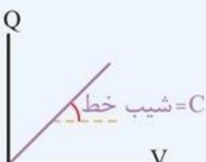
**نکته:** نمودار بار خازن بر حسب ولتاژ آن مطابق شکل زیر است: شیب این خط برابر ظرفیت خازن است.
