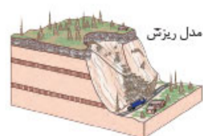
سقوط آزاد سنگ‌ها و خرده‌سنگ‌ها در سطح دامنه‌های پرشیب و پرتگاهی
